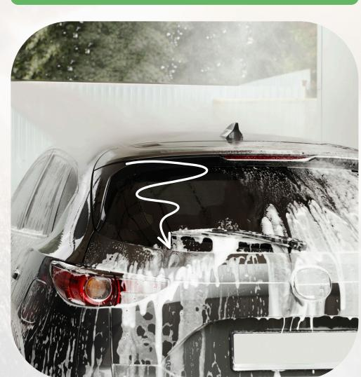
تكون زاوية مسدس ضخ المياه بزاوية 45 درجة لتغطية جسم السيارة بشكل اسرع وأكبر
